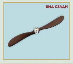
Возьмите ось винта (гвоздик) и кусачками укоротите ее до 8 мм. Вставьте ее без клея с обратной стороны в деталь EN11 (носок картера), а затем вклейте в отверстие во втулке винта. Старайтесь, чтобы клей прочно удерживал винт, но не «прихватил» ось к детали EN11. После высыхания клея пропеллер должен свободно вращаться.
