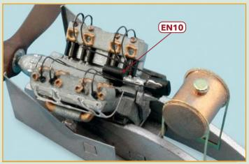
25 Извлеките из стальной пластины-заготовки деталь В11 и отогните ее расчетверенные концы, как показано на снимке, а затем вклейте их в отверстия детали В10 на левом блоке цилиндров. Противоположный конец согните и приклейте к картеру, находящемуся между деталями EN9 и EN10.
